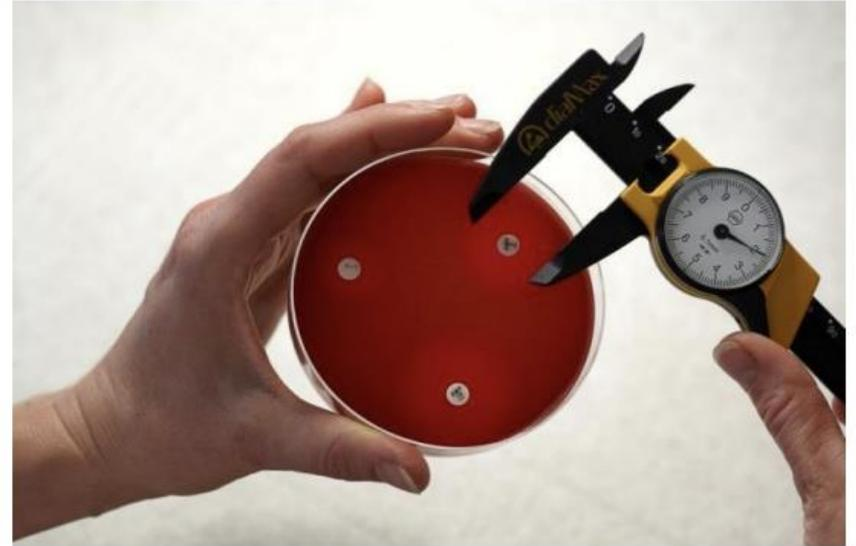
Leitura da placa sem tampa, observando a superfície que contém os discos, sob luz refletida.
