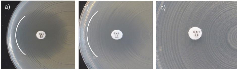
**Exemplos de halos de inibição de *A. xylosoxidans* ao testar sulfametoxazol-trimetoprima.**
